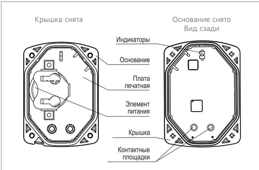
Конструкция извещателя герметичная. Для включения режима регистрации в радиосети в случае полностью собранного корпуса реализован способ двойного кратковременного (на 1-2 с) замыкания контактных площадок. Режим будет включен на время 60 с от момента второго замыкания. В разобранном состоянии обеспечивается запуск режима регистрации с помощью лазерного пульта. При нормальной работе в радиосети режим регистрации не включается без специальных мер
