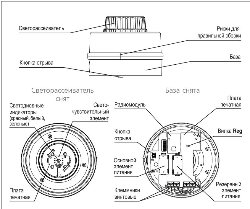
Вилка **Reg** служит для включения на оповещателе режима регистрации в радиосети. Для этого выполняется кратковременное замыкание вилки (на 1 - 2 с) с последующим нажатием кнопки отрыва (ТМП). Режим будет включен на время 60 с от момента замыкания вилки. При нормальной работе в радиосети режим регистрации не включается без специальных мер
