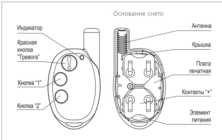
Кнопки «1» и «2» служат для регистрации в радиосети, а также для просмотра и ручной смены радиочастотного канала в случае необходимости. Регистрация выполняется одновременным нажатием кнопок «1» и «2» после запуска режима регистрации на УОП
