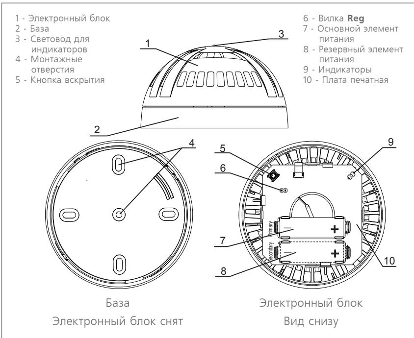
Вилка **Reg** служит для включения на извещателе режима регистрации в радиосети. Для этого выполняется кратковременное замыкание вилки (на 1 - 2 с) с последующим нажатием кнопки вскрытия (ТМП). Режим будет включен на время 60 с от момента замыкания вилки. При нормальной работе в радиосети режим регистрации не включается без специальных мер
