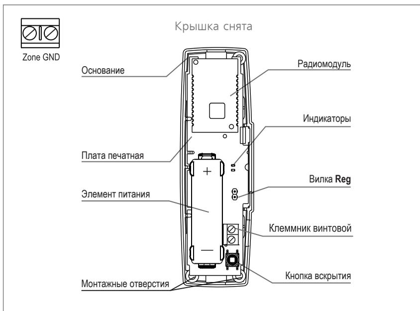
Вилка **Reg** служит для включения на извещателе режима регистрации в радиосети. Для этого выполняется кратковременное замыкание вилки (на 1-2 с) с последующим нажатием кнопки вскрытия (ТМП). Режим будет включен на время 60 с от момента замыкания вилки. При нормальной работе в радиосети режим регистрации не включается без специальных мер
