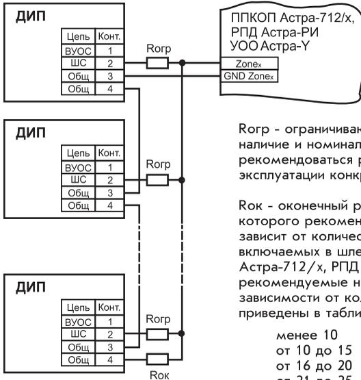
Рогр - ограничивающий резистор, наличие и номинал которого должны рекомендоваться руководством по эксплуатации конкретного типа ДИП
