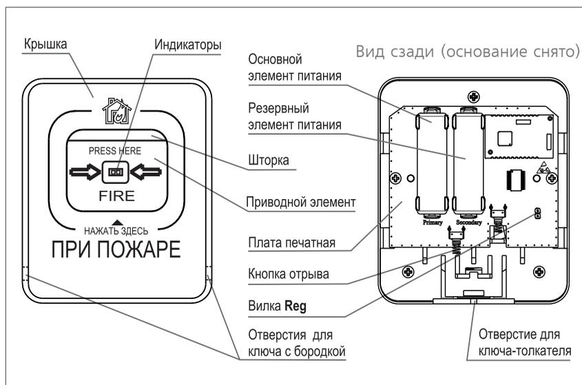
Вилка **Reg** служит для включения на извещателе режима регистрации в радиосети. Для этого выполняется кратковременное замыкание вилки (на 1 - 2 с) с последующим нажатием кнопки отрыва (ТМП). Режим будет включен на время 60 с от момента замыкания вилки. При нормальной работе в радиосети режим регистрации не включается без специальных мер
