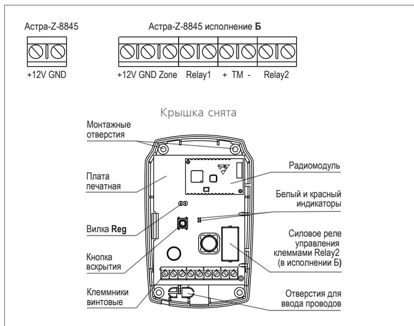
Вилка **Reg** служит для включения на ретрансляторе-маршрутизаторе режима регистрации в радиосети. Для этого выполняется кратковременное замыкание вилки (на 1-2 с) с последующим нажатием кнопки вскрытия (ТМП). Режим будет включен на время 60 с от момента замыкания вилки. При нормальной работе в радиосети режим регистрации не включается без специальных мер
