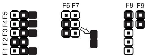
При использовании прибора с заводскими установками, считываемыми из памяти прибора, необходимо удалить перемычку **F7**. При этом положение перемычек **F1 – F6** прибором игнорируется.
