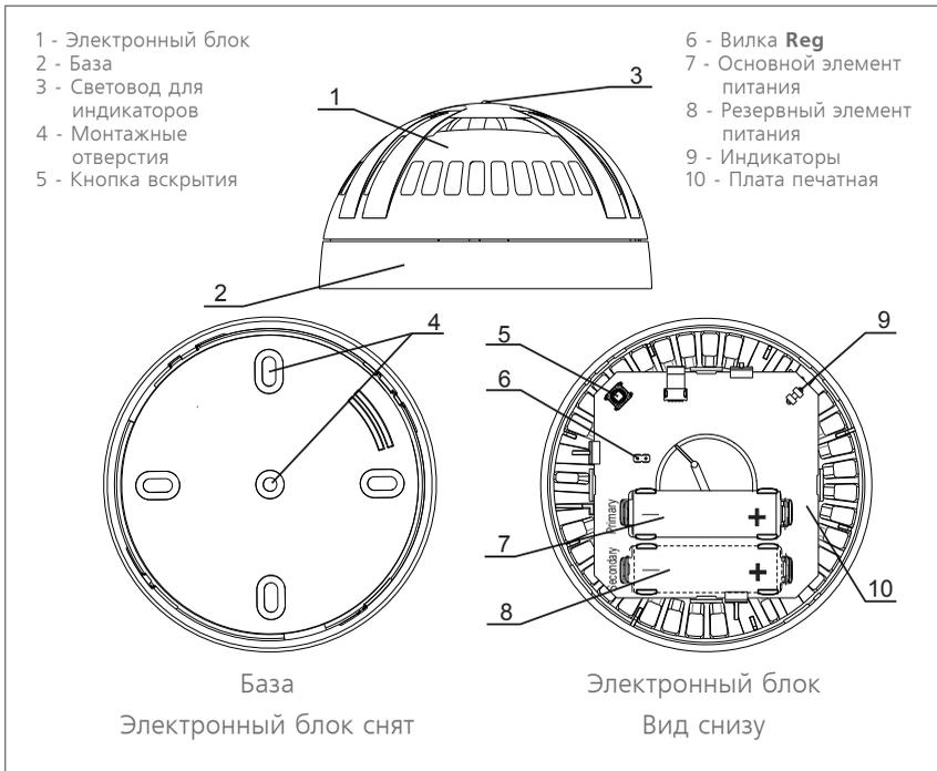
Вилка **Reg** служит для включения на извещателе режима регистрации в радиосети. Для этого выполняется кратковременное замыкание вилки (на 1 - 2 с) с последующим нажатием кнопки вскрытия (ТПП). Режим будет включен на время 60 с от момента замыкания вилки. При нормальной работе в радиосети режим регистрации не включается без специальных мер
