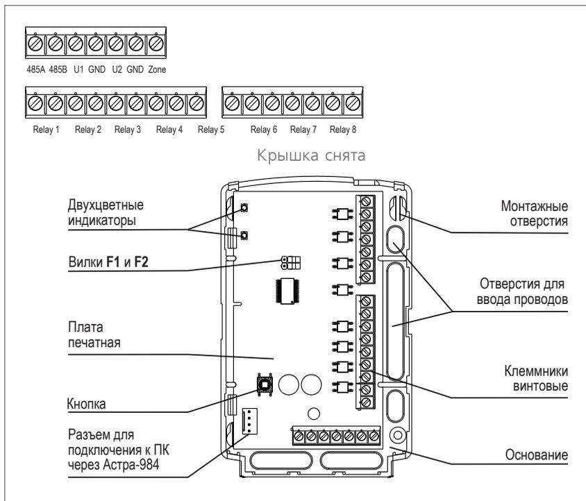
Вилки предназначены для регистрации (перерегистрации) блока Астра-824 в центральном ППКОП и блокировки кнопки вскрытия
