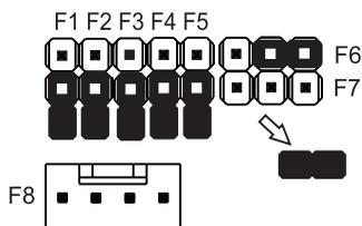
При использовании прибора с заводскими установками, считываемыми из памяти прибора, необходимо удалить перемычку **F7**. При этом положение перемычек **F1 – F6** прибором игнорируется.
