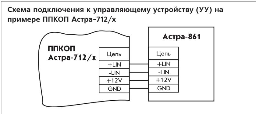
При подсоединении к ППКОП Астра-712/х по линии расширения блок сразу начинает отображать состояния соответствующих ШС.
