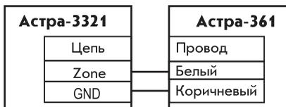
Астра-3321 в режиме радиопередатчика - установлена переключателем вилке **Emod**
