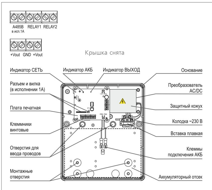
Разъем в исполнении 1А предназначен для подключения модуля ЕСОП, в текущей версии не используется
