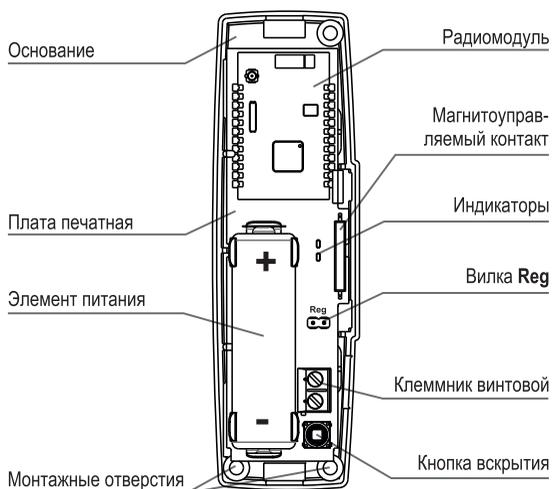
Вилка **Reg** служит для включения на извещателе режима регистрации в радиосети. Для этого выполняется кратковременное замыкание вилки (на 1 - 2 с) с последующим нажатием кнопки вскрытия (ТМП). Режим будет включен на время 60 с от момента замыкания вилки. При нормальной работе в радиосети режим регистрации не включается без специальных мер
