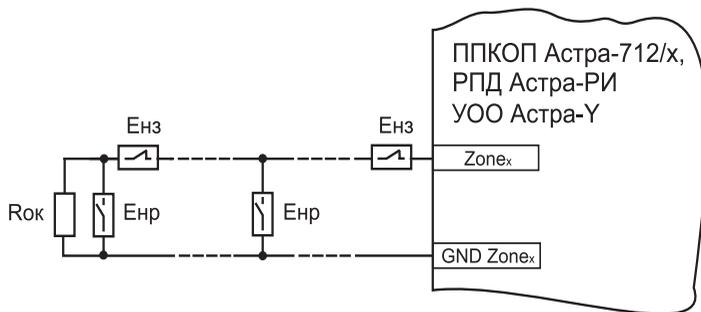
**Енз** - извещатель с замкнутыми контактами выходного реле в состоянии «Норма»
