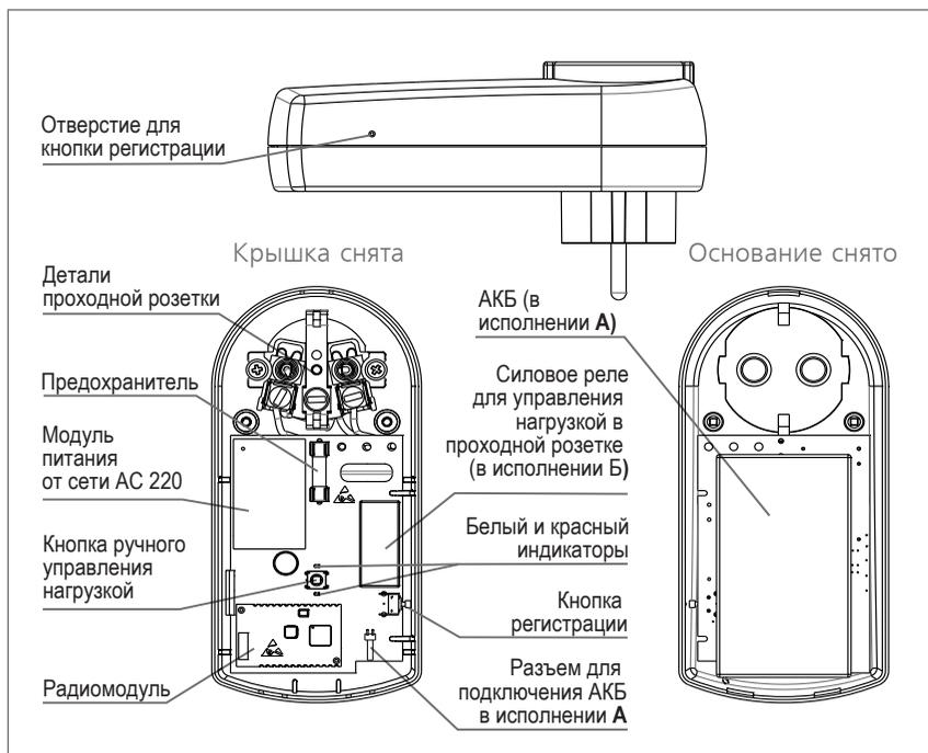
Кнопка регистрации служит для включения на ретрансляторе/маршрутизаторе режима регистрации в радиосети. Для этого выполняется кратковременное нажатие с помощью (на 1 - 2 с) с помощью подручного предмета типа канцелярской скрепки. Режим будет включен на время 60 с от момента нажатия кнопки. При нормальной работе в радиосети режим регистрации не включается без специальных мер
