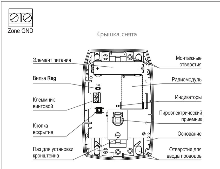
Вилка **Reg** служит для включения на извещателе режима регистрации в радиосети. Для этого выполняется кратковременное замыкание вилки (на 1 - 2 с) с последующим нажатием кнопки вскрытия (ТМП). Режим будет включен на время 60 с от момента замыкания вилки. При нормальной работе в радиосети режим регистрации не включается без специальных мер
