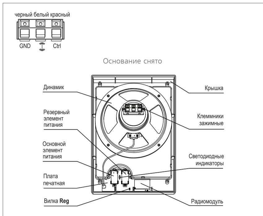
Вилка **Reg** служит для включения на оповещателе режима регистрации в радиосети. Для этого выполняется кратковременное замыкание вилки (на 0,5-2 с), включится красный индикатор. В течение 60 с после выключения красного индикатора повторно замкнуть вилку Reg на 0,5-2 с. При нормальной работе в радиосети режим регистрации не включается без специальных мер
